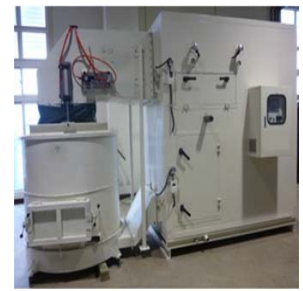
低能耗機械式蒸發 濃縮設備(MVR) 處理化學鎳廢液
