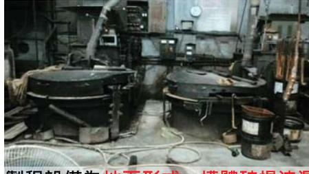
製程設備為地下形式、槽體破損洩漏
