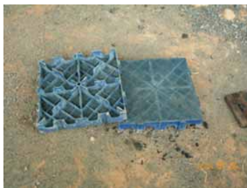
圖 3 曬乾床用之 PU 濾材
