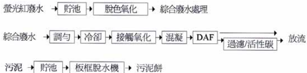
圖 1 廢水處理流程
