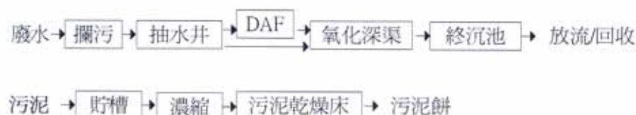
圖 1 廢水處理流程
