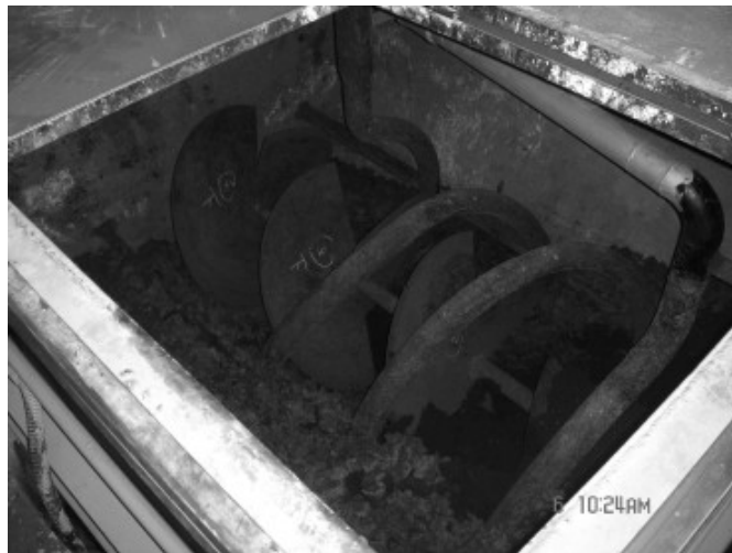
圖 3 污泥斗中增設攪拌器
