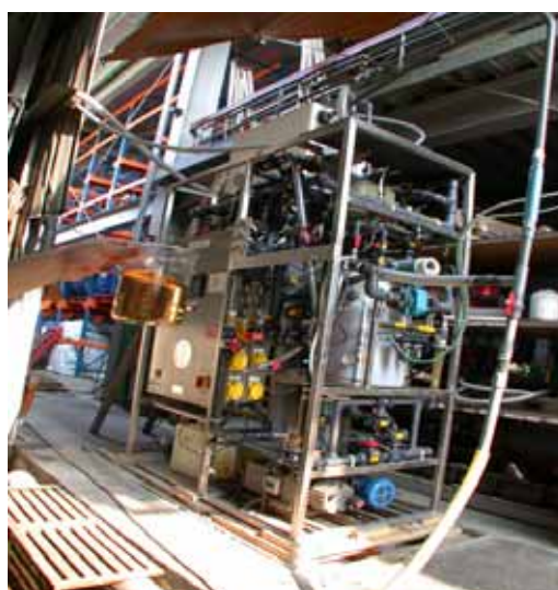
圖 14.2 國外 MBR 廠商所進行之模廠 ( Q=6.3\text{gpm}=34\text{CMD} )
