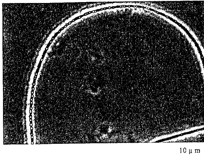
照片5.11 曝氣槽中彎曲狀之白硫絲菌
