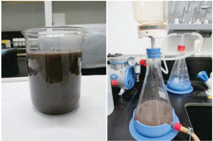
圖 4 晶背研磨廢水外觀及穿透濾紙
