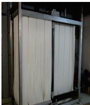
圖 6 沉浸式 UF 單膜箱外觀
