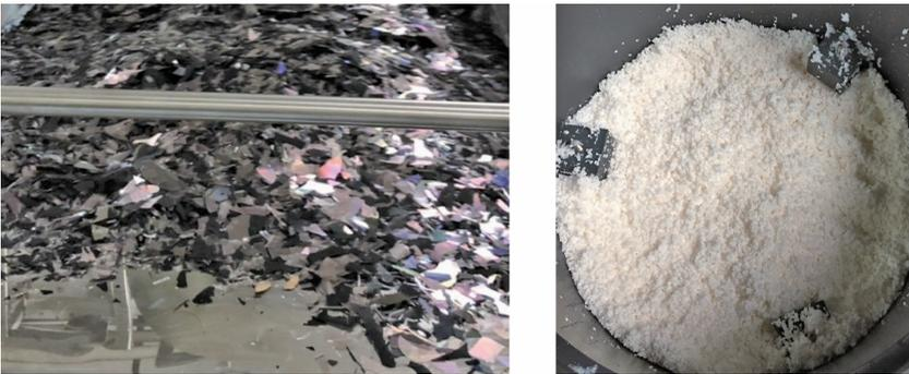
圖 2 LCD 玻璃改質成玻璃奈米孔洞吸附材料，(左) 萃取後廢 LCD 玻璃；(右) LCD 玻璃奈米孔洞吸附材料
