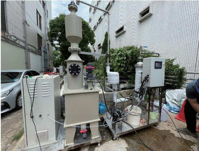
圖 7 氣提 / 觸媒氧化整合系統
