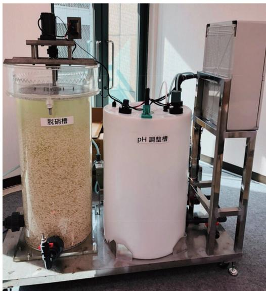
圖 17 生物球脫硝系統模組
