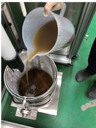
圖 16 將蒐集的澄清液倒入連續滴定沉析攪拌裝置
