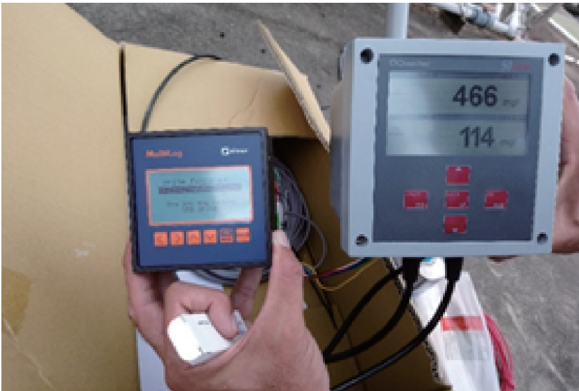
圖 4 偵測傳訊器 (圖右) 及紀錄器 (圖左)
