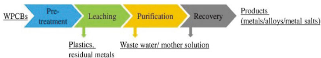
圖 4 印刷電路板廢棄物之濕法冶金回收技術。(Bui, 2021；流程細節請參見上述說明)
