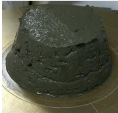
圖 5 輕質建築材料加水混合後狀態。(以表 3 NO7 配方為例)
