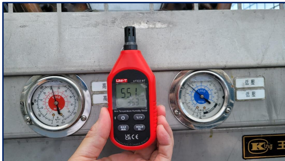
圖 12 冷凝器的高低壓值(在外氣 35.3℃ 條件)
