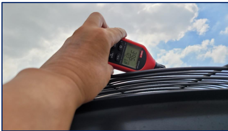
圖 13 冷凝器的出風溫度( =42.1^{\circ}\text{C} )
