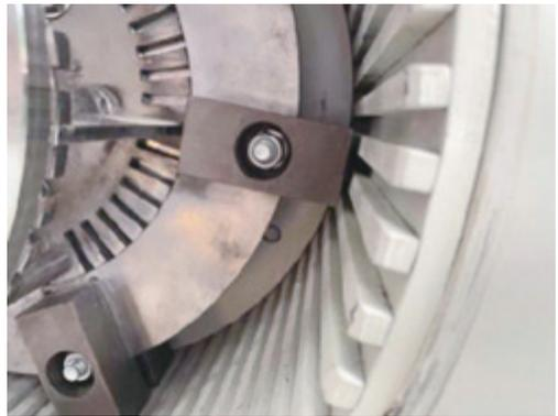
圖 5 磨粉機內部構造
