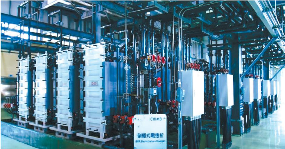
圖 1 某樹脂及塑膠製造廠之 EDR 系統 (工業技術研究院創新水科技研發服務網)
