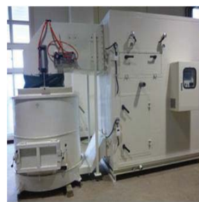
低能耗機械式蒸發 濃縮設備(MVR) 處理化學鎳廢液
