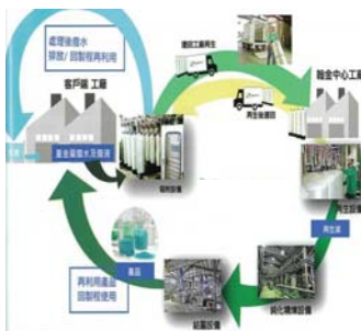
應用離子交換樹脂塔回 收鎳離子，飽和後由資 源化工廠再生回收，達 到循環經濟目的
