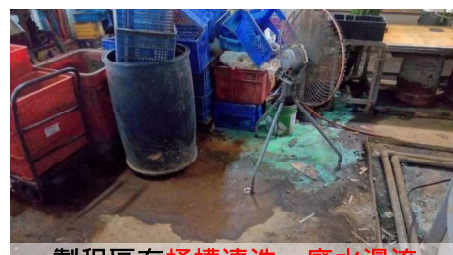
製程區有桶槽清洗、廢水漫流
