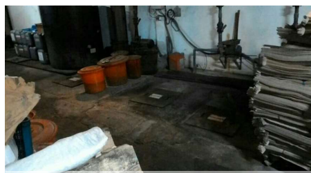
有空桶清洗、廢水槽體/管線地下式
