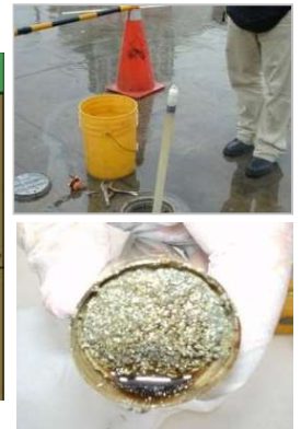
• 劇烈搖晃震盪後結果 • 土壤孔隙中不再移動之液態有機(NAPL)污染物 - 持久性污染源
