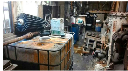
廢水處理區廢水溢流、鋪面不完整
