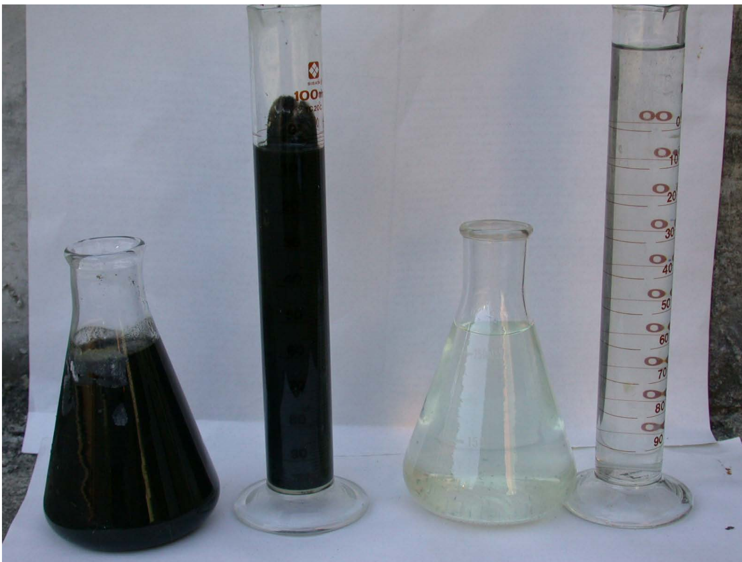
厭氣池污泥及處理後溢流水
