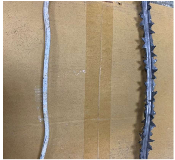
舊陰極線(腐蝕前後比較圖(左: 腐蝕後、右: 原電級))
